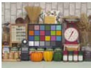
撮影サンプル画像(400ルクス) ※F1.4、露光時間16.7msec、Gain 0dB
