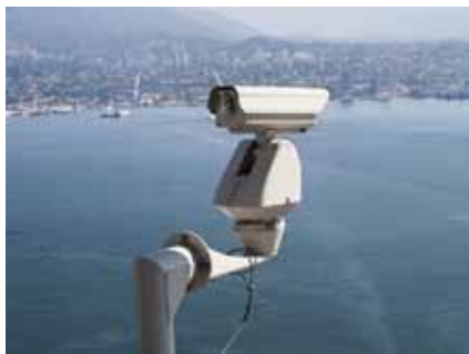
▲境界部や重要基盤、海港や空港など、昼夜を問わず広い場所を効率よく監視できるカメラが必要な環境では、通常長焦点カメラを設置している。
