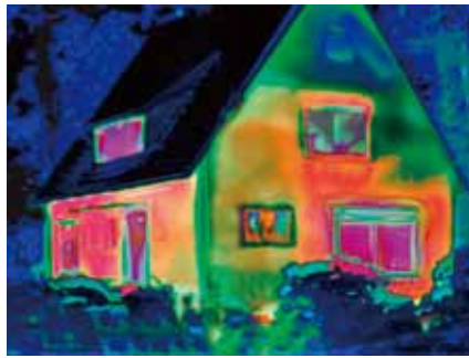
▲サーマルカメラで表示される画像は、視野中の様々な物体が放射している熱の高低を表したもので、細部を見分けることはできない。
